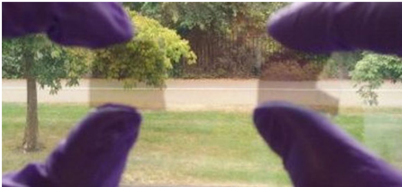
Figure 1 : Des échantillons du nouveau verre dans les deux modes, montrant que la lumière les traverse de manière à peu près identique. Source: Université d'Oxford.
