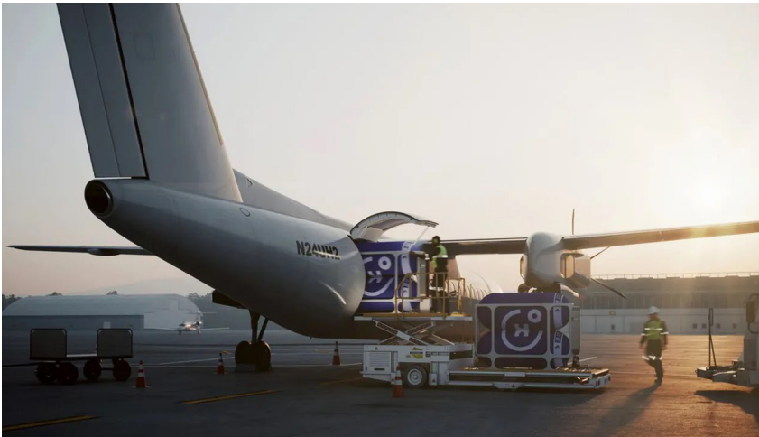
Figure 4 : Chargement de réservoirs/capsules d'hydrogène dans un ATR72-600 à hélices – (Source : Universal Hydrogen).
