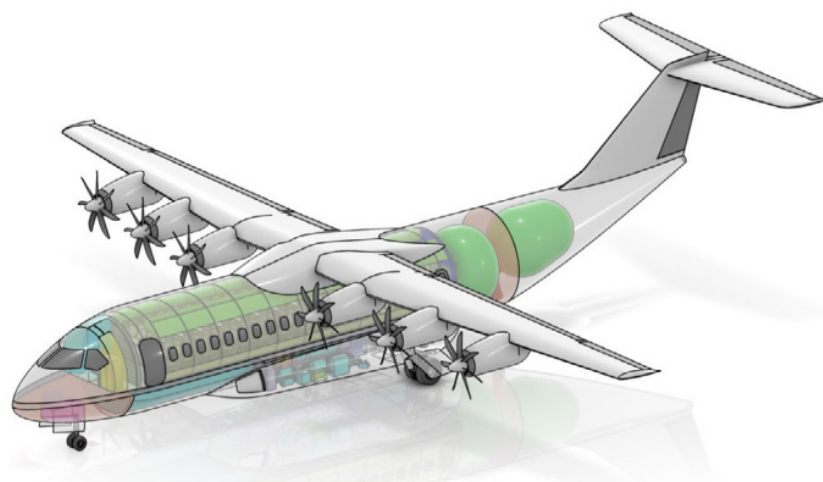
Figure 5 : Projet FlyZero – concept avion régional sur la base d'ATR72-600 – Source : Aerospace Technology Institute.
