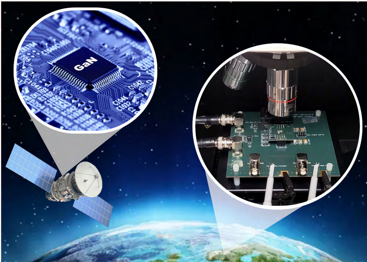
Caractérisation au sol de la sensibilité aux radiations des composants GaN avant leur utilisation dans l'espace.
