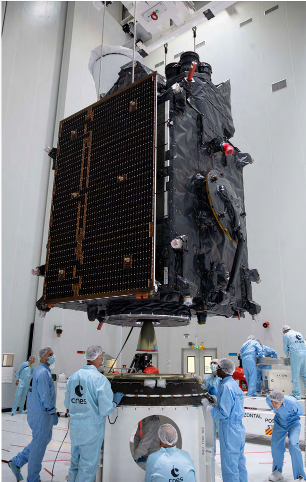
Figure 2 : Intégration du satellite MTG-I sur son support de lancement – Source : ESA.
