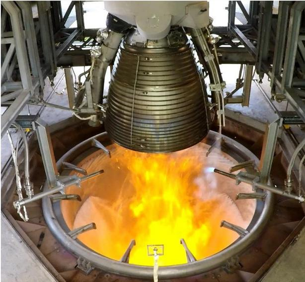
Figure 3 : Essai du moteur Vulcain 2.1. Crédits : CNES/ESA/Arianespace-Arianespace/CSG.
