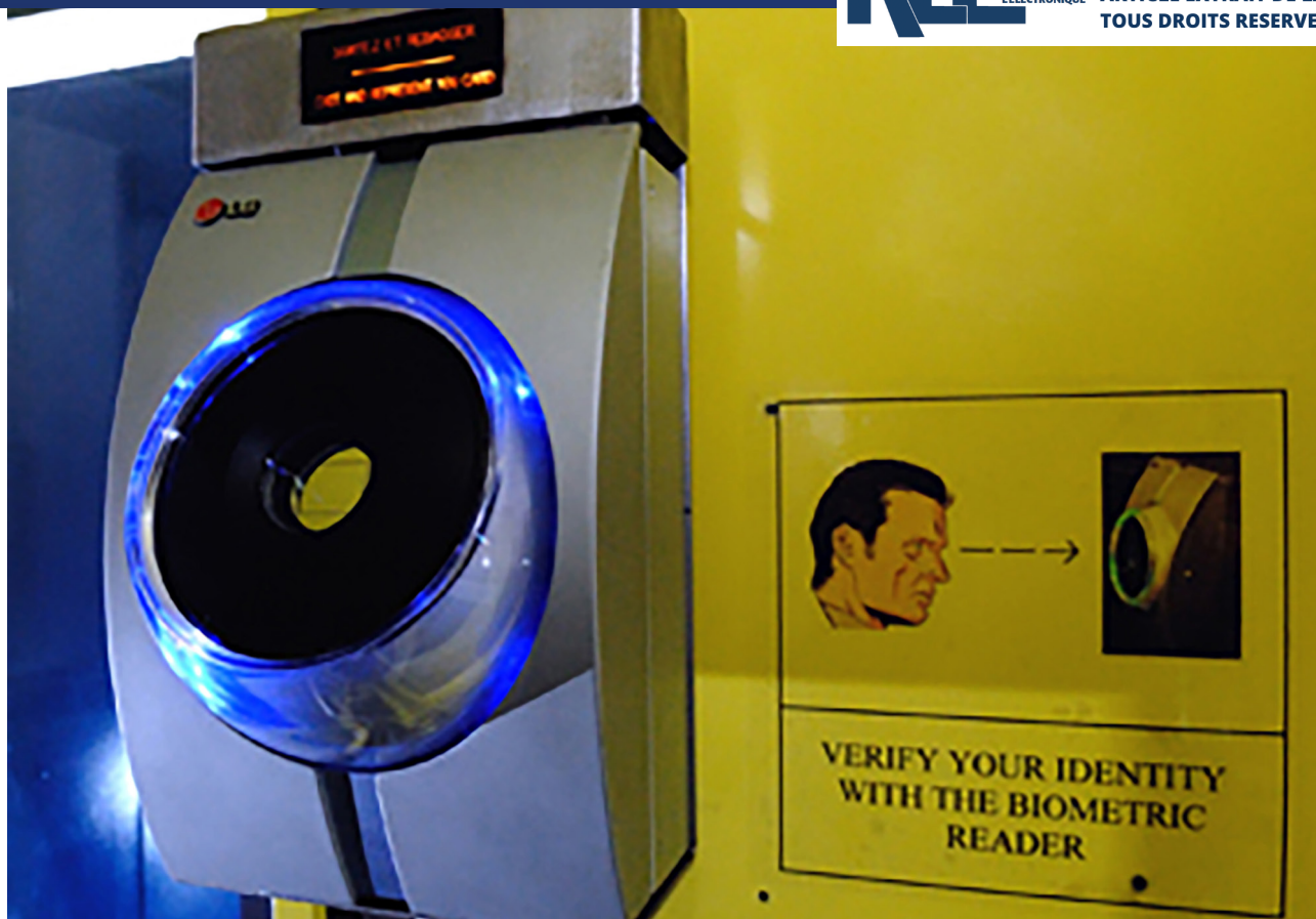
Accès contrôlé par reconnaissance d'identité à partir des caractéristiques de l'iris – Source Cern Document Server.
