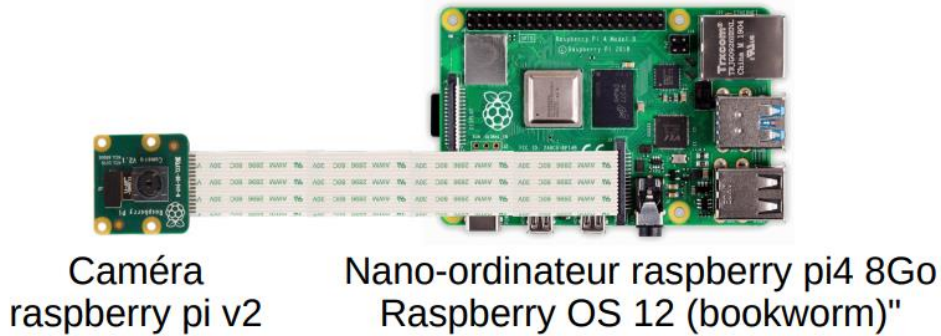
Figure 2 : Équipements utilisés pour la localisation via Apriltags
