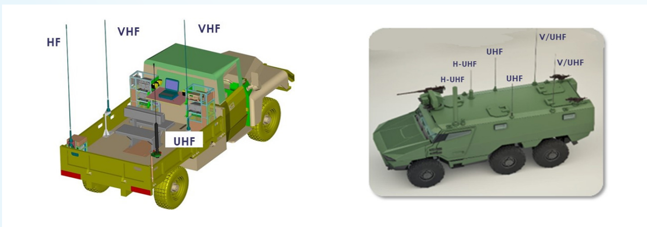
Figure 2 : Exemple d'implantation complexe de radios sur un véhicule militaire terrestre.
