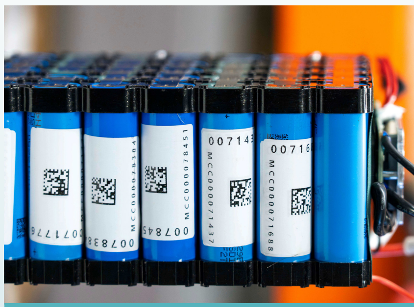
Figure 1 : Vue d'éléments de batterie reconditionnés par VoltR.
