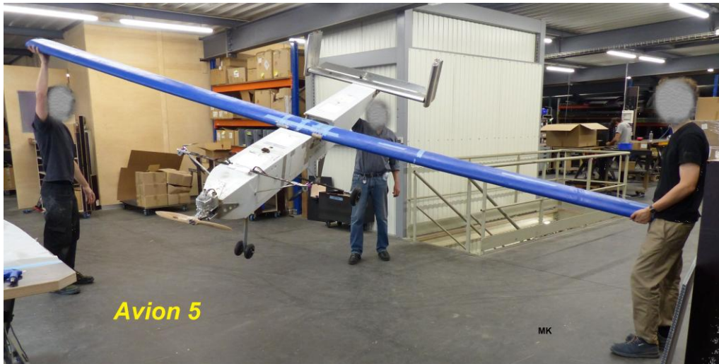
Figure 9 : Avion 5, dérivé à aile composite hypersustentée à grand allongement (envergure 5 m), temps de vol de 15 à 30 heures selon la charge embarquée
