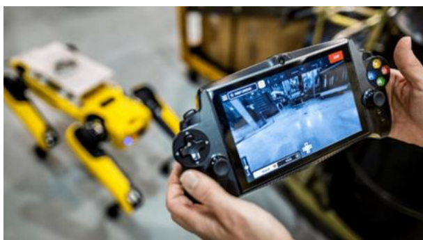
Figure 3 : Pilotage manuel ou Navigation autonome de SpotMini
