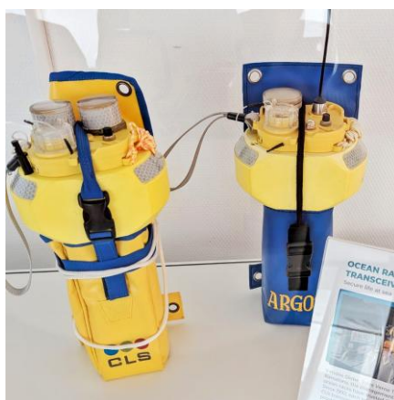
Figure 1 : Les balises ARGOS utilisées pour localiser les navires du Vendée Globe depuis les premières éditions de la course
