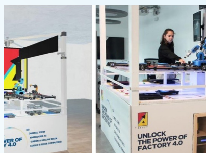
ALTEN - Connexion en temps réel entre équipements industriels (Mini Plant 4.0) et jumeau numérique, via MQTT et OPC UA, pour l'analyse, la simulation et la collaboration à faible latence.
