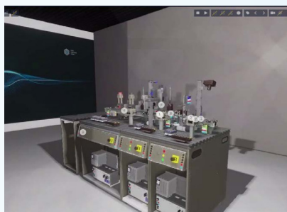
FESTO - MPS 403 & son jumeau numérique : former autrement, partout, et au plus près de l'industrie 4.0. Véritable référence pédagogique, la MPS 403 de FESTO offre une expérience immersive pour explorer, programmer et dépanner une ligne de production — réelle ou virtuelle — afin de développer les compétences industrielles de demain.
