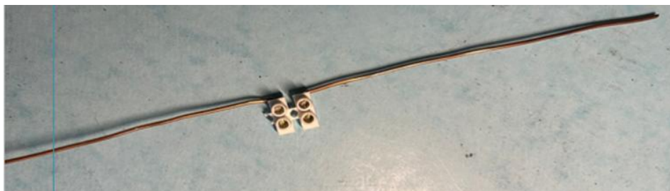
Figure 7 : Montage d'un dipôle à l'aide d'un domino
