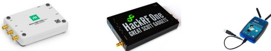
Figure 13 : À gauche : usrp b206 mini-i, au milieu : HackRF One, à droite : Pluto SDR. Trois dispositifs SDR compatibles émission.
