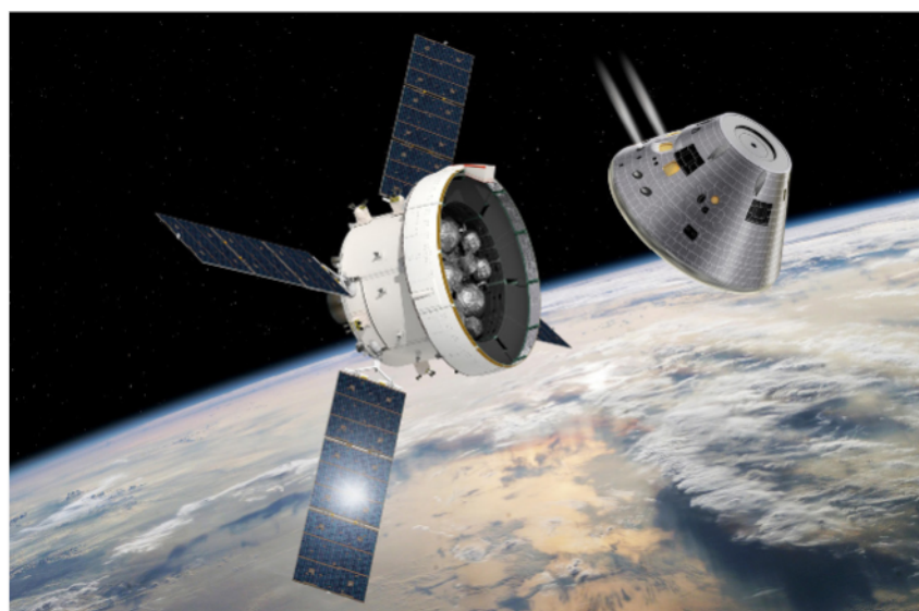
Figure 8 : Vue d'artiste de la séparation de l'ESM et le vaisseau habité Orion avant sa rentrée dans l'atmosphère.
