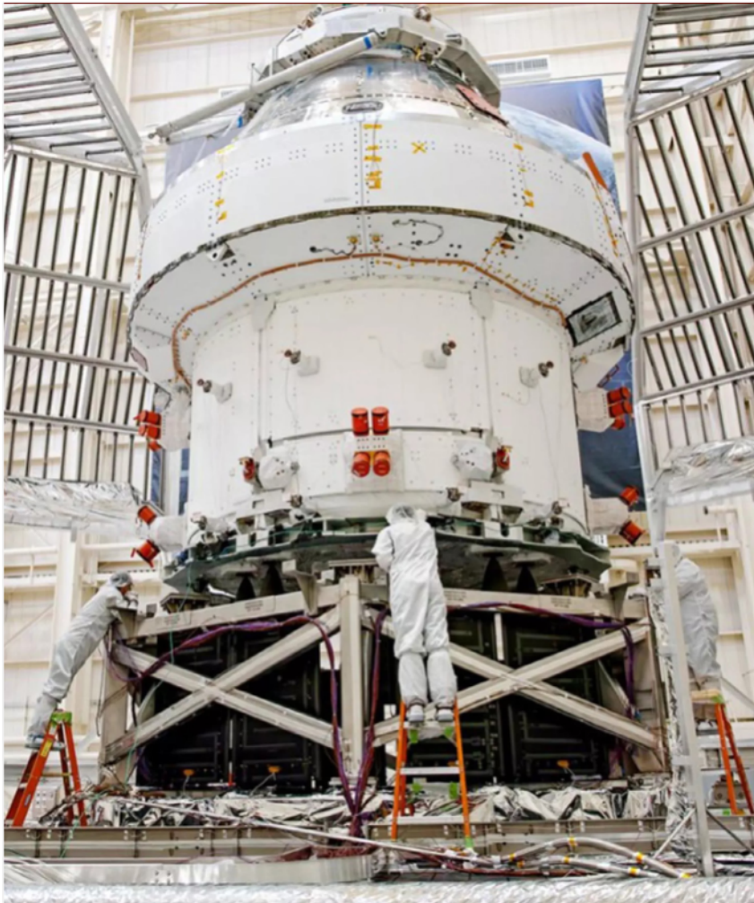
Figure 2 : Le module European Space Module en intégration à la NASA. Source : ESA. On distingue des objets rouges (les « Reds ») qui sont des capots de protection et qui doivent tous être ôtés avant le décollage.
