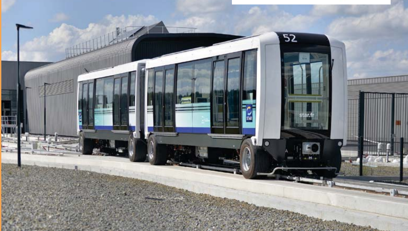
Le métro entièrement automatique Cityval pour la ligne b du métro de Rennes, en phase d'essais dynamiques au garage atelier – © Siemens
