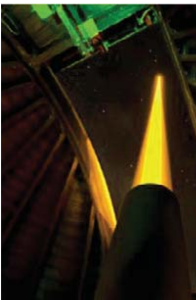
Figure 3 : Laser jaune utilisé en astronomie pour la création d’étoiles artificielles - Source ESO.
