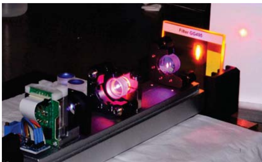
Figure 2b : Laser à rubis pompé par diode (2020) - Source: Dr. Walter Luhs. Pendant la décennie 1960-1970, furent inventés la majorité des lasers utilisés de nos jours : diodes lasers, lasers à CO 2 , lasers Nd : YAG, lasers à fibre, lasers à colorant, lasers à excimère. Les recherches destinées à la réalisation de nouveaux lasers ont conduit vers des horizons de puissance de l'ordre du pétawatt ou, à l'autre bout de la chaîne, vers la miniaturisation des lasers.
