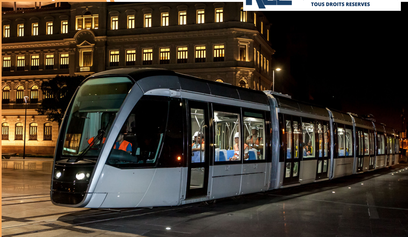
Tram sans caténaire Citadis, fabriqué par Alstom, équipé de supercondensateurs, en service à Rio de Janeiro - ©VLT Carioca.
