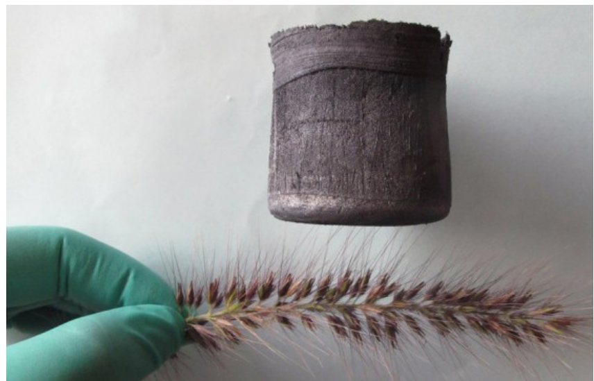
Figure 5 : Aérogel de carbone obtenu à partir d'un alliage carbone-métal (carbure) où le métal a été dissous dans l'acide. Ce matériau extrêmement poreux a une masse volumique proche de celle de l'air.
