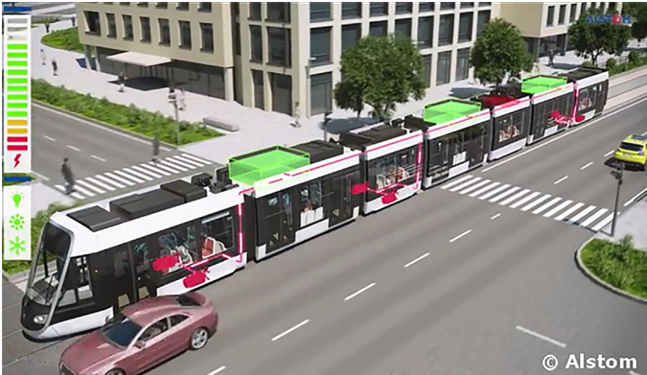
Figure 6 : Tramway de Nice, sans caténaire, utilisant des supercondensateurs (en vert) pour alimenter les moteurs (en rouge) et récupérer l'énergie de freinage [5].
