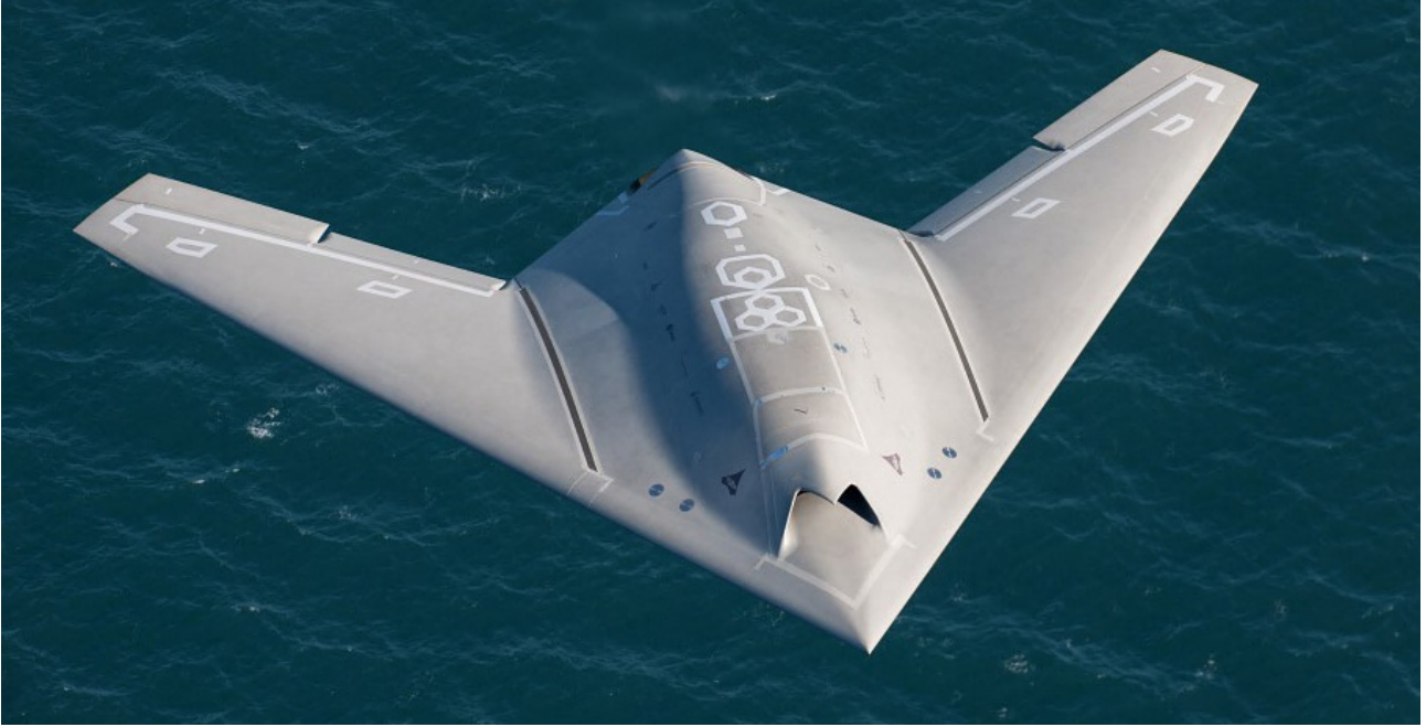
Figure 3 : Démonstrateur de drone de combat Neuron en vol - © Dassault Aviation- A. Pecchi
