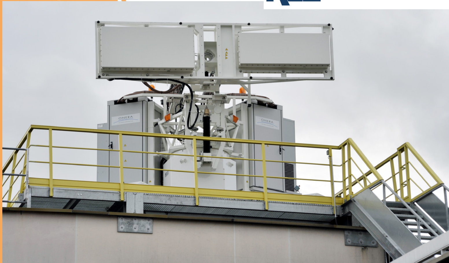
Station radar expérimentale HYCAM qui permet notamment l'analyse haute résolution de la signature radar en vol des avions. Source ONERA/J.P. Bébert.
