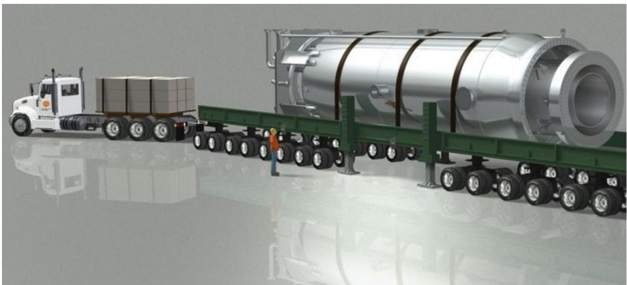
Figure 3 : Vue d'un module Nuscale sur camion, pour transport vers le site - Source SFEN/RGN.
