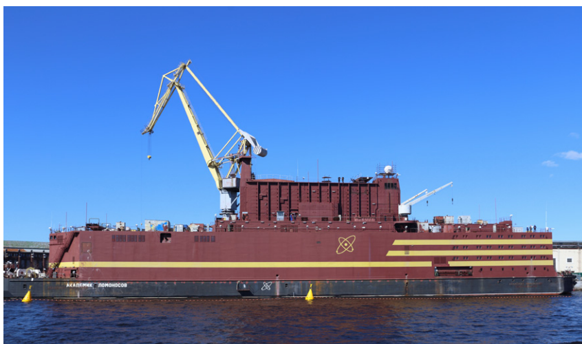
Figure 4 : Vue de la barge flottante de 35 MWe développée par Rosatom et mise en service en 2020.
