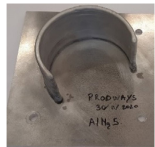
Figure 2 : Exemples de composants aéronautiques imprimés directement par la technologie WAAM.
