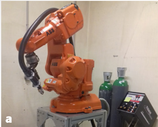
Figure 1 : Exemple de système d'impression pilote « FLEX WAAM » de Mines Saint-Etienne (a) et de la future machine pour prototypage de composants industriels (b).
