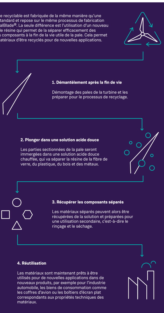
Figure 2 : Cycle des opérations permettant la réutilisation d'une pale recyclable. © Siemens Gamesa.
