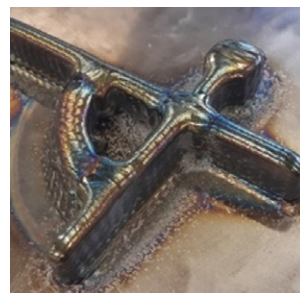
Figure 2 : Exemples de composants aéronautiques imprimés directement par la technologie WAAM.
