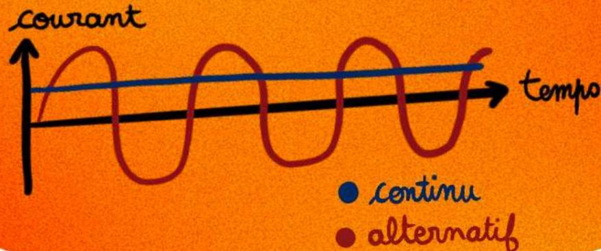
SAUF QUE CES DERNIERS PRODUISENT DE L'ÉLECTRICITÉ À COURANT CONTINU. ELLE EST CONVERTIE POUR ÊTRE DISTRIBUÉE EN COURANT ALTERNATIF PAR LE BIAS D'UN CONVERTISSEUR.
