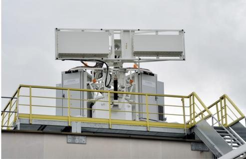
Station radar expérimentale HYCAM qui permet notamment l'analyse haute résolution de la signature radar en vol des aéronefs. Source ONERA/J.P. Bébert.
