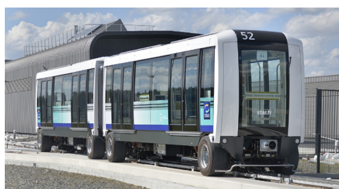
Le métro entièrement automatique Cityval pour la ligne b du métro de Rennes, en phase d'essais dynamiques au garage atelier— © Siemens
