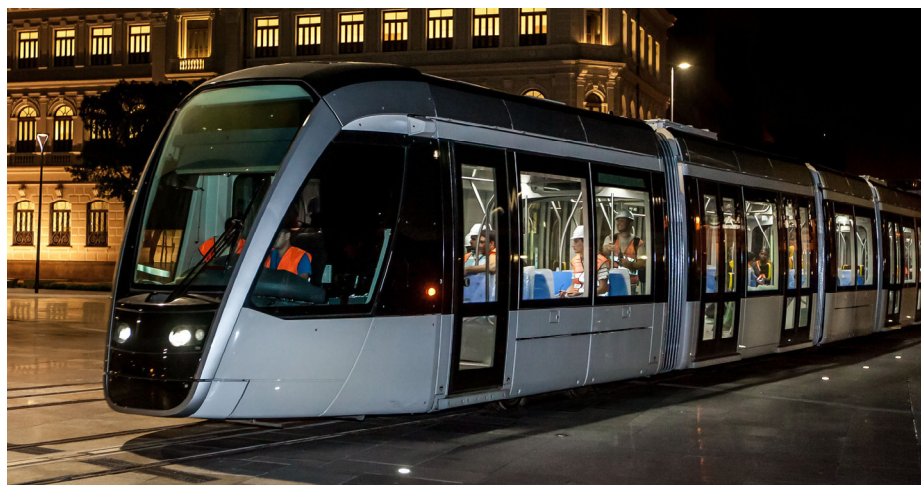
Tram sans caténaire Citadis, fabriqué par Alstom, équipé de supercondensateurs, en service à Rio de Janeiro - ©VLT Carioca.
