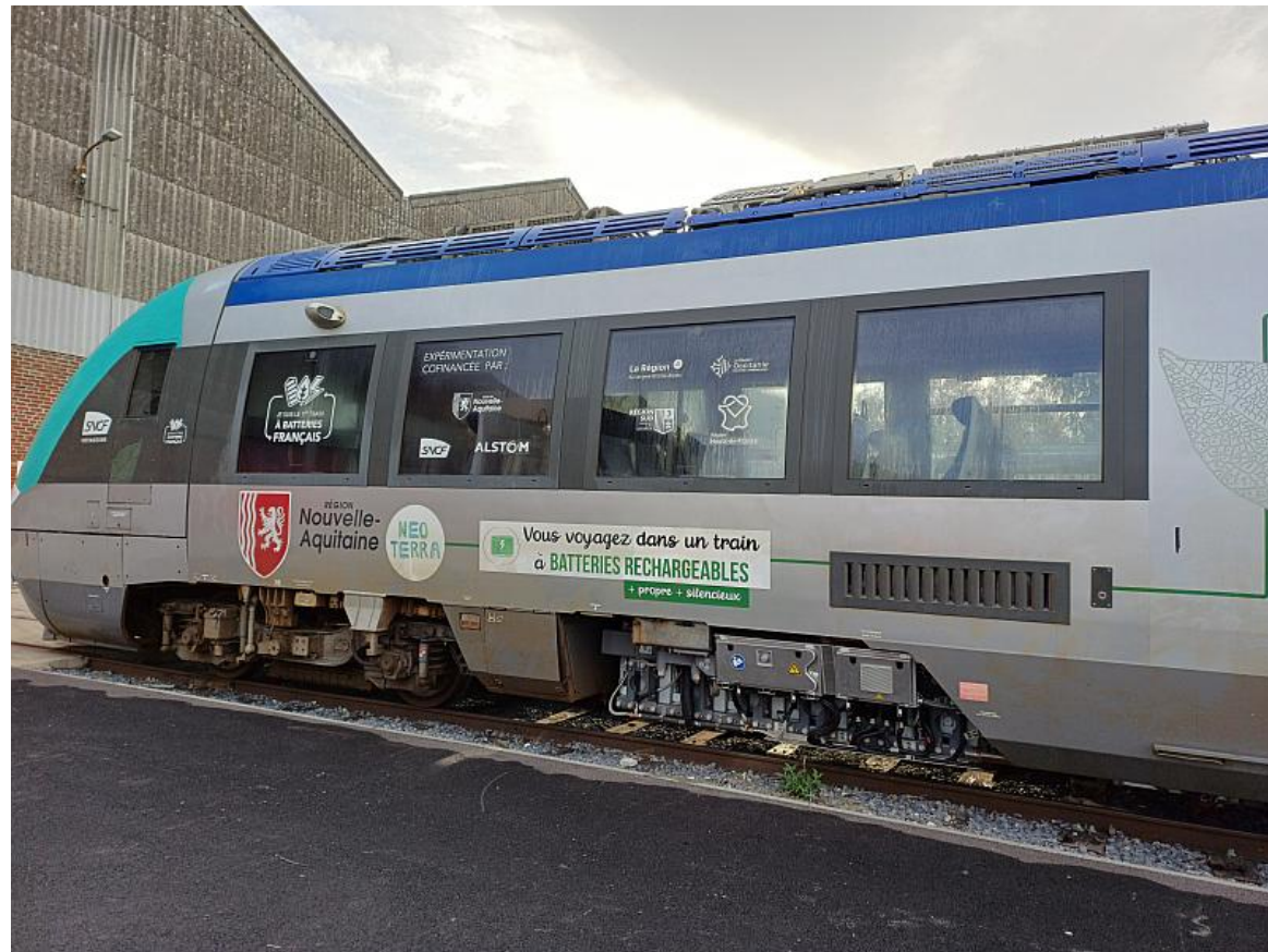
8 batteries dans chaque motrice
