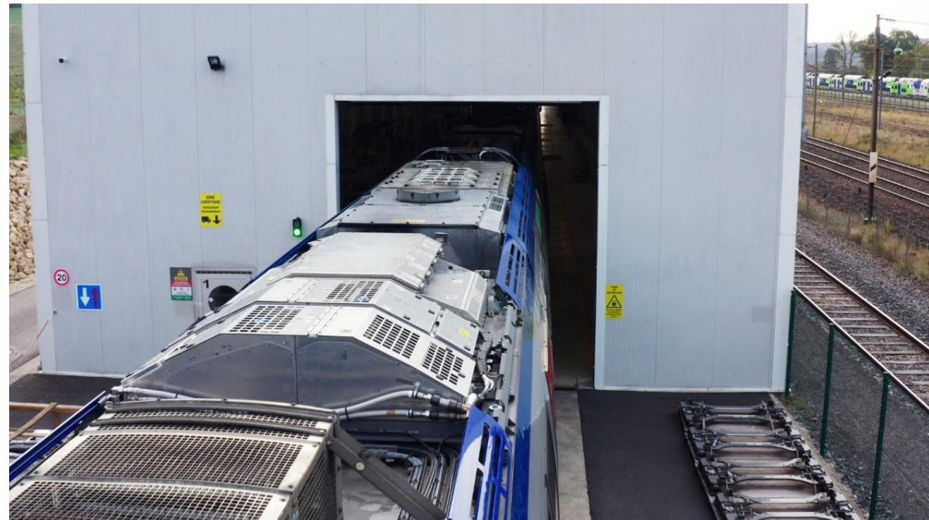
4 groupes de refroidissement et 2 coffres DC/DC sont installés sur une rame
